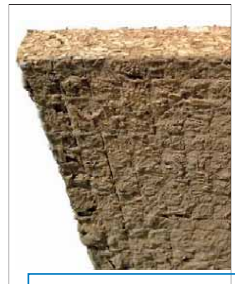
Struktur einer Strohbaumatte.
