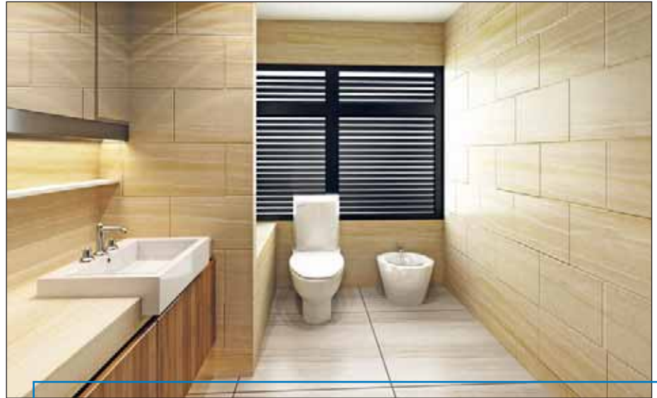
Badezimmer mit großformatigen Feinsteinzeugfliesen als Wand- und Bodenbelag.
