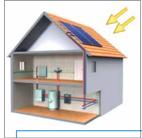
Funktionsweise einer Solarthermieanlage.
